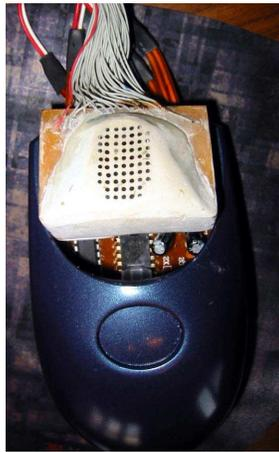
FIG. 13 – Souris électrotactile à 64 électrodes (Source : [14])
